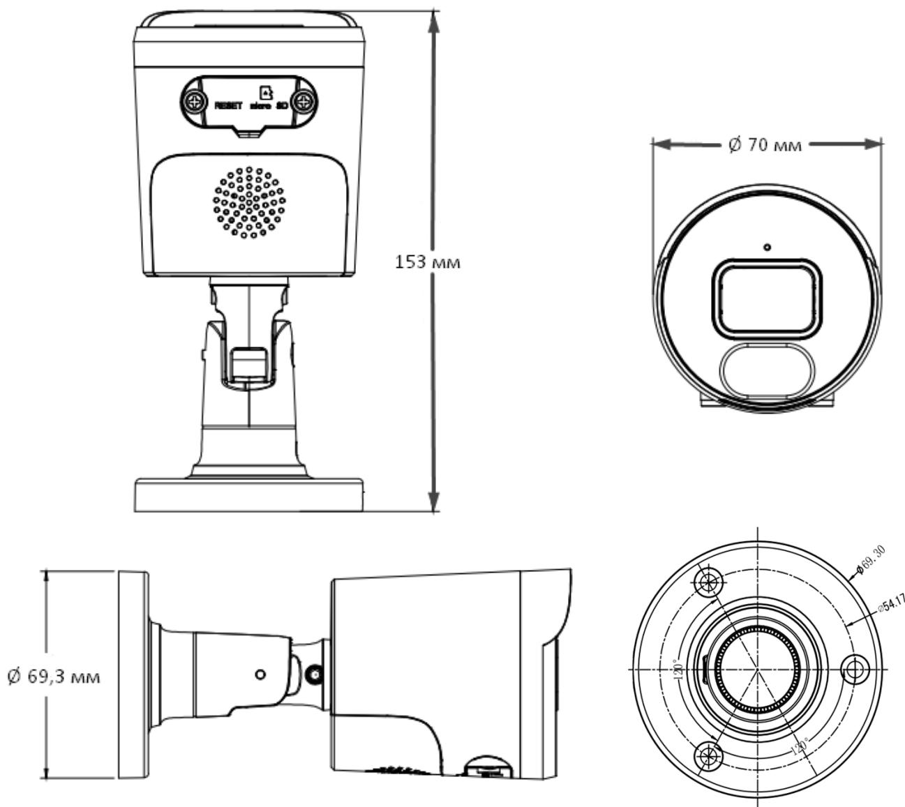
Слот для SD-карты и кнопка сброса настроек находятся под герметичной заглушкой на корпусе видеокамеры.
