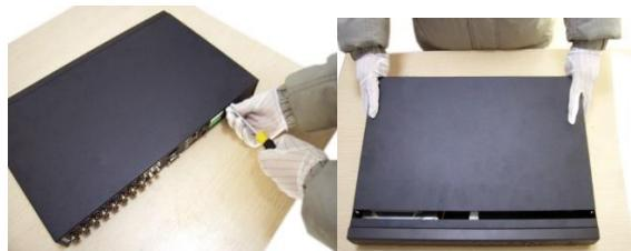
Открутите шурупы и снимите верхнюю крышку устройства
