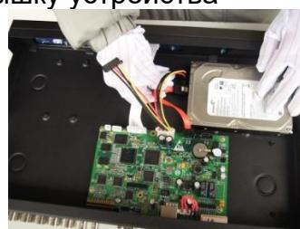
Совместите отверстия в креплении жесткого диска и в нижней части устройства (**внутри устройства!**).
