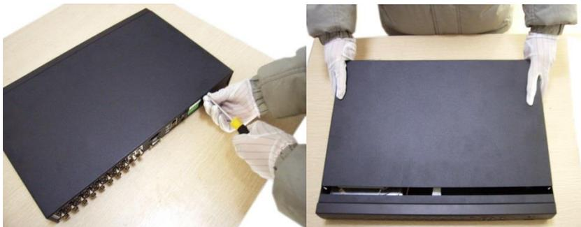
Открутите шурупы и снимите верхнюю крышку устройства
